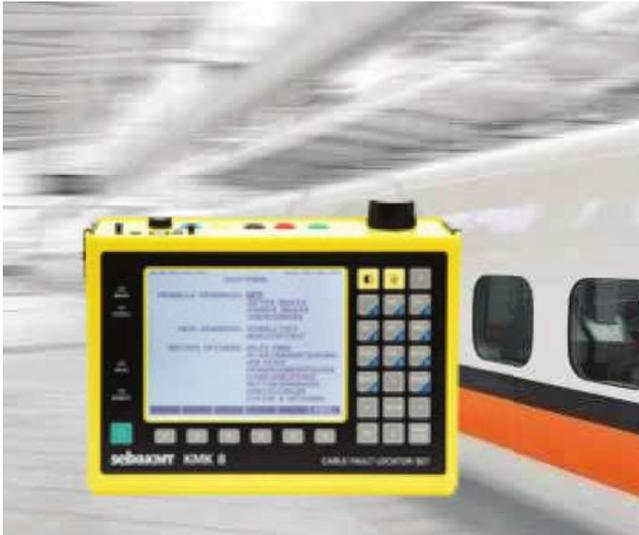
guasti viene effettuata con l'ausilio di parametri già predefiniti ed integrabili e può tenere conto anche della temperatura.
