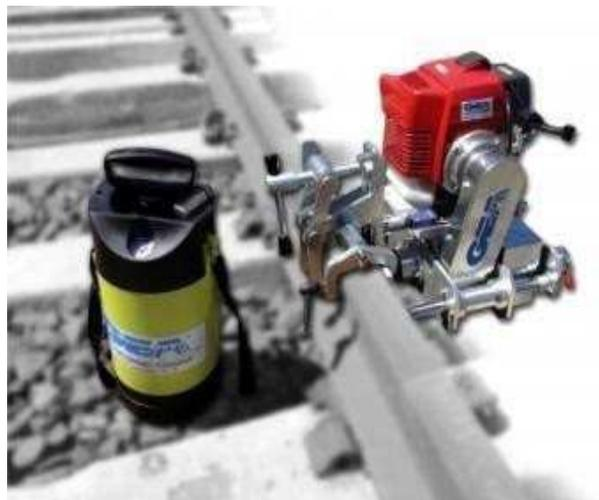
Trapano forarotaie ad avanzamento automatico della fresa. Completo di maschere di foratura e recipiente per il liquido lubrificante.
