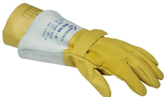
Idonei a proteggere meccanicamente i guanti isolanti Electrovolt e conservare un'adeguata destrezza. Palmo in pelle fiore, manichetta in crosta, regolazione a strappo.
